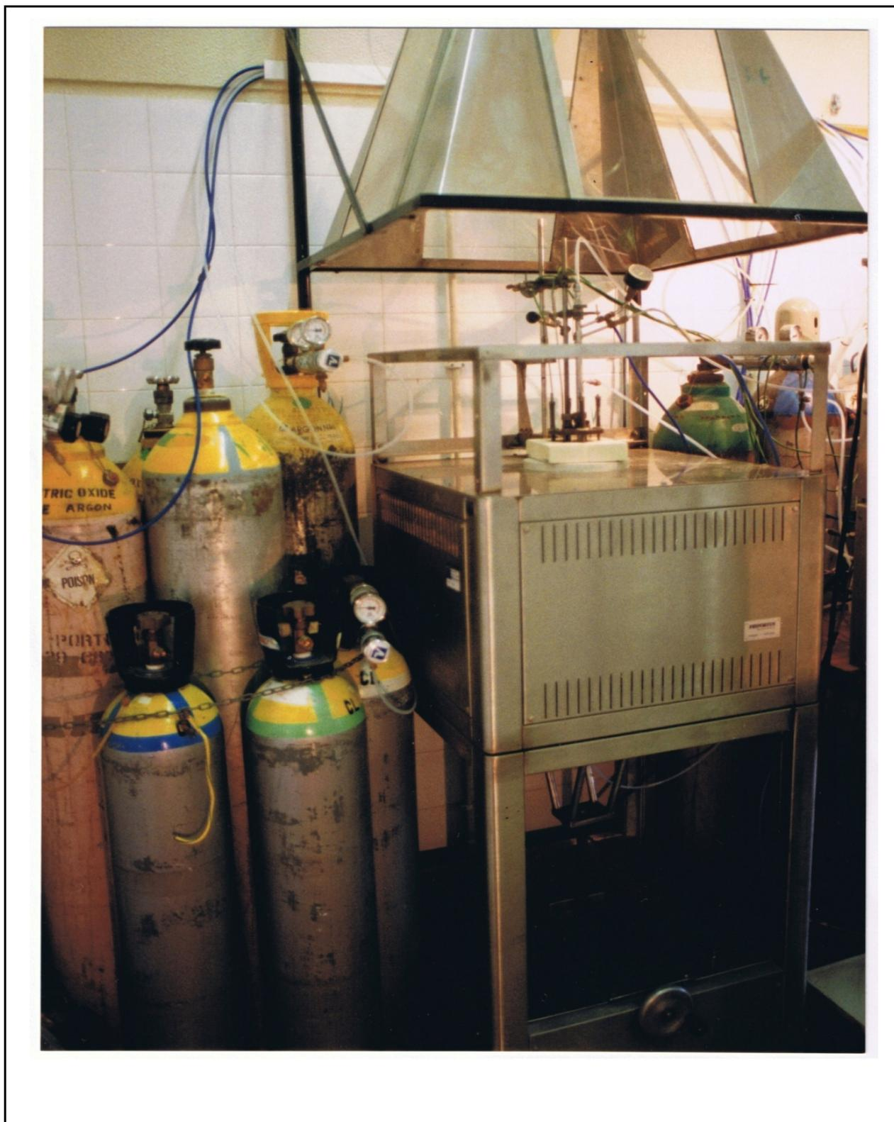
Figura 2.14 – Aspecto geral da instalação do reactor laboratorial RLFZ, do forno e garrafas de gás
