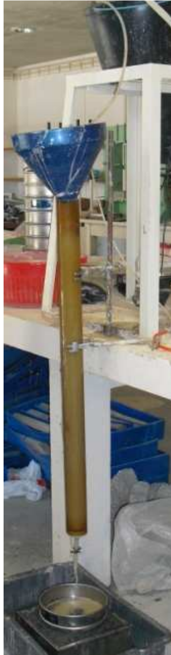
Figura 11: Coluna de corrente ascensional perturbada, no Departamento de Geociências da Universidade de Aveiro.
