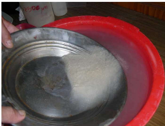
Figura 12: Método da bateia; verificamos que as partículas de moscovite aderem à interface da água e flutuam, enquanto outros minerais como o quartzo, o feldspato e a caulinite se depositam no fundo da bateia.
