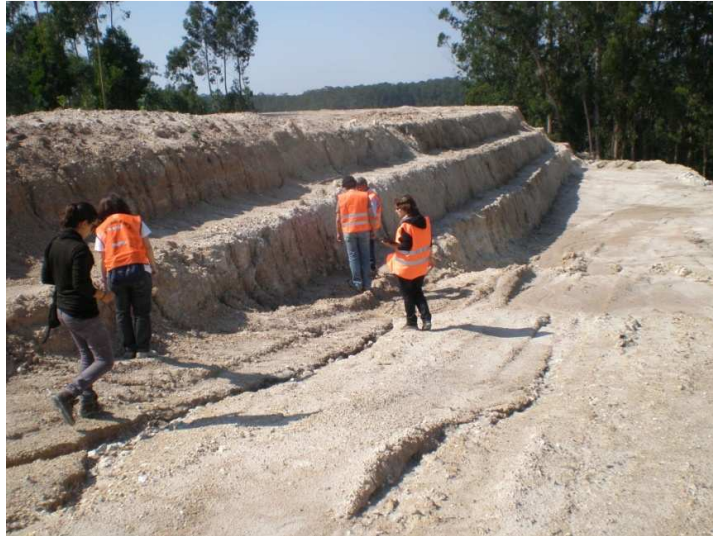
Figura 5: Aspecto da exploração de caulinos em bancadas em São Vicente de Pereira Jusã.
