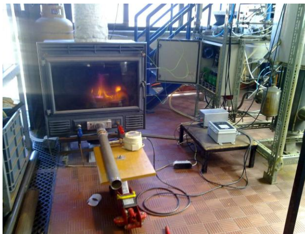
Figura 6 - Recuperador de calor em operação
