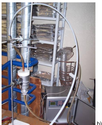
Figura 8 - Analisadores de gás e sistema de aquisição de dados (a)), amostrador de partículas (b)) e sistema de recolha de COV (c)).
