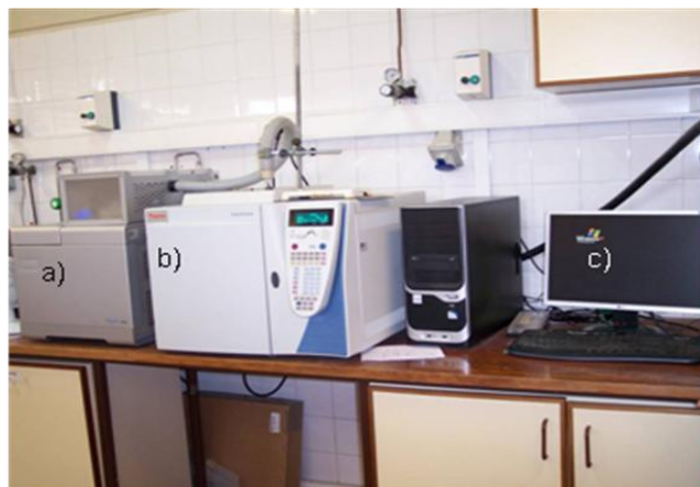
Figura 16 - Sistema cromatográfico de análise de COV: a) injetor; b) GC-FID; c) computador.
