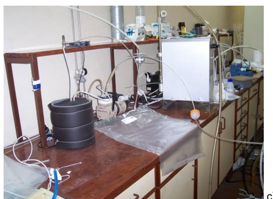
Figura 8 - Analisadores de gás e sistema de aquisição de dados (a)), amostrador de partículas (b)) e sistema de recolha de COV (c)).
