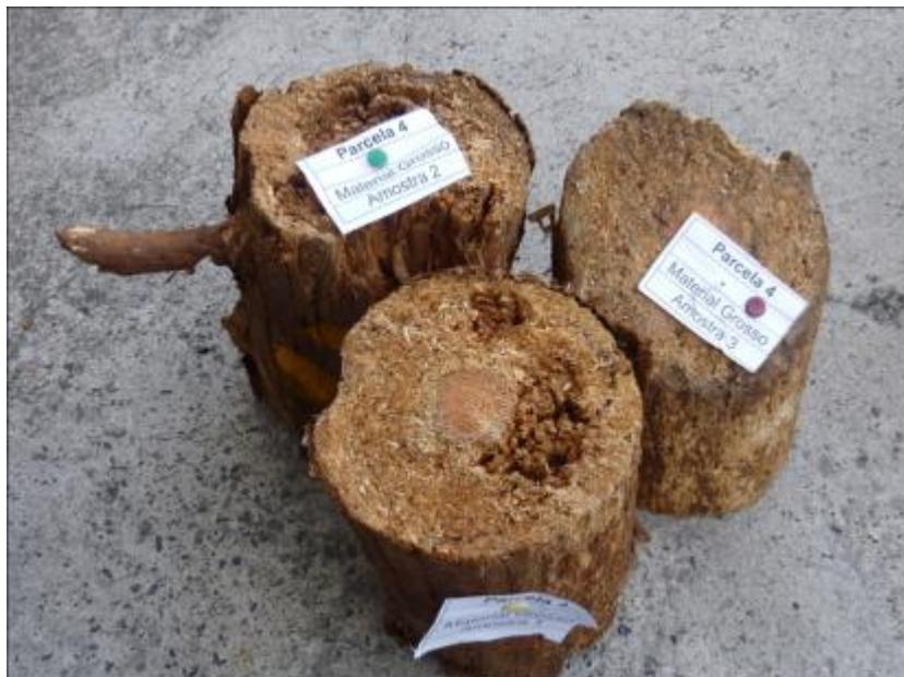
**Figura 36 – Exemplo de material grosseiro retirado para determinação das densidades verde e seca da *Cryptomeria japonica* (Ponte et al., 2011).**
