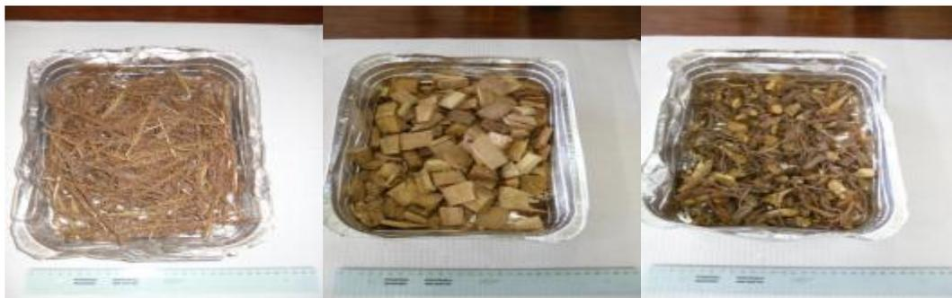
**Figura 14 - Acondicionamento das amostras de biomassa em caixa de alumínio para secagem ao ar no laboratório.**
