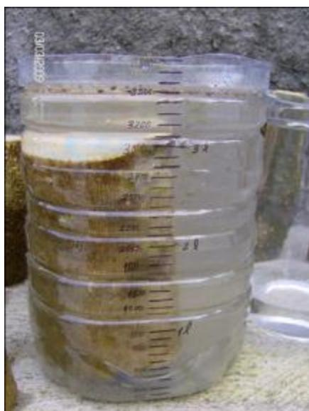
**Figura 37 - Determinação do volume “verde” da *Cryptomeria japonica* por Imersão (Ponte et al., 2011).**
