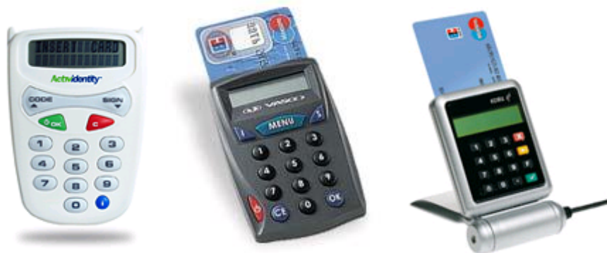
Figura 3 - Exemplo de leitores de smartcard destinado à autenticação via EMV-CAP. O teclado serve para introduzir o PIN do titular do cartão, o ecrã serve para mostrar a senha única (OTP)
