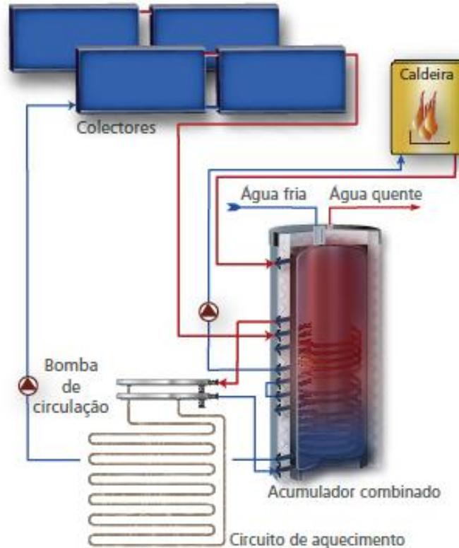
**Figura 23** - Princípio de funcionamento do sistema solar de aquecimento central e AQS [39].
