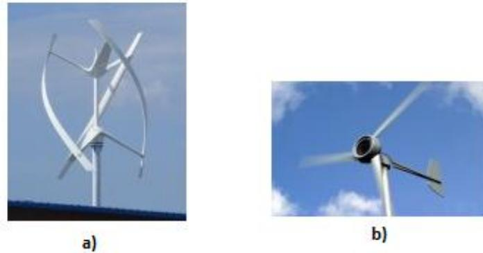
**Figura 6** - Tipos de micro-turbinas eólicas típicas: a) Eixo vertical e b) Eixo horizontal [18].
