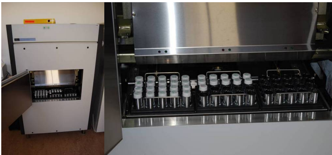
Figura 12 - Espectrómetro de cintilação líquida ultra-sensível Perkin Elmer Quantulus 1220, para a determinação de diversos radionuclídeos (cortesia do Laboratório de Radioatividade Natural, DCT|FCTUC).
