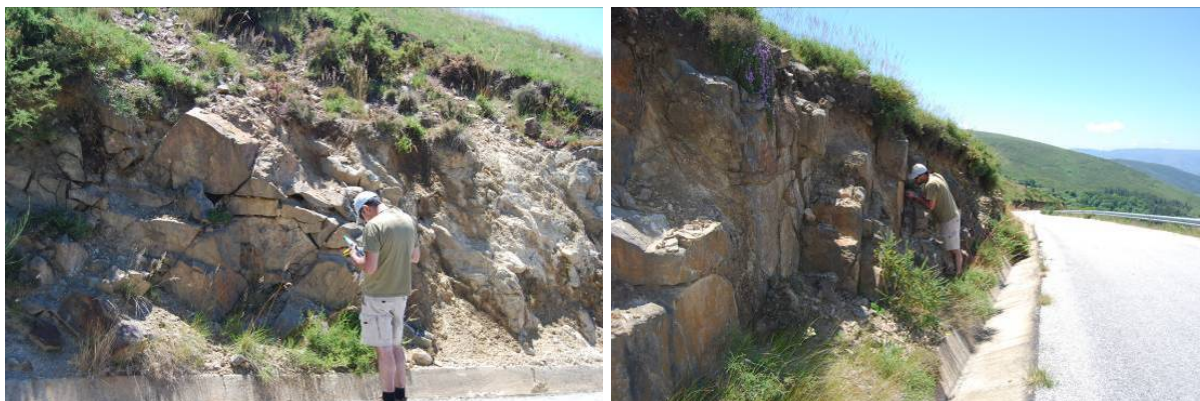
Figura 178 – Aspecto da georreferenciação do final do Pannel 2, onde se observam descontinuidades subverticais e sub-horizontais e aspecto do ensaio esclerométrico em descontinuidades.
