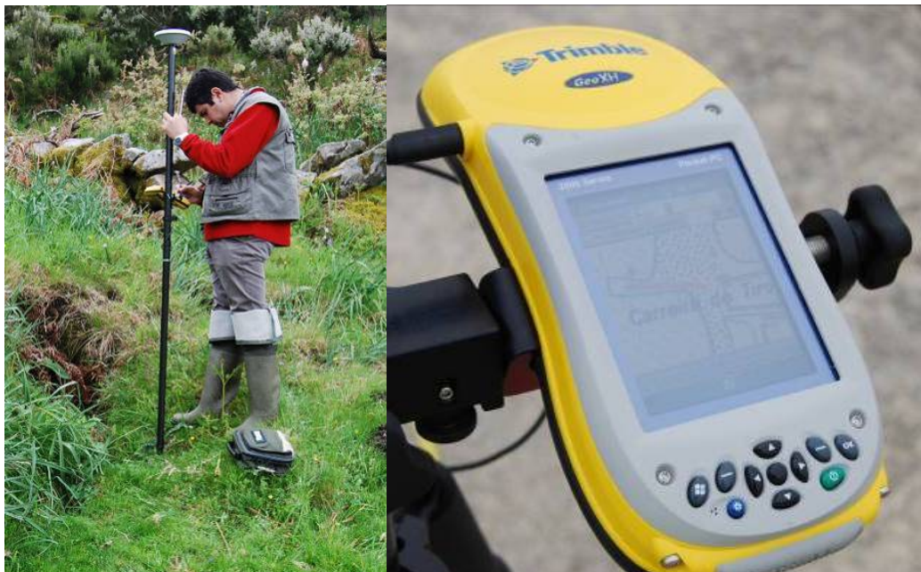
Figura 9 – Exemplo da utilização do GPS de alta precisão Trimble® GeoExplorer XH2008 na georreferenciação de pontos de água e foto de pormenor do equipamento.
