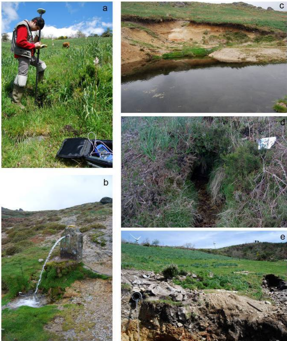
Figura 217 – Aspectos do inventário hidrogeológico da área da Noninha. a) Aspecto da georreferenciação de uma ocorrência de água no grupo de nascentes designado por Nascentes de S. Pedro das Meadilhas (PI34); b) Fonte de S. Pedro (PI25); c) Aspecto de nascente e charca no topo da Serra de S. Pedro (PI30); d) Aspecto da nascente do Caminho do Vale do Asno (PI32); e) Aspecto dos furos horizontais realizados junto às antigas nascentes de S. Pedro das Meadilhas.
