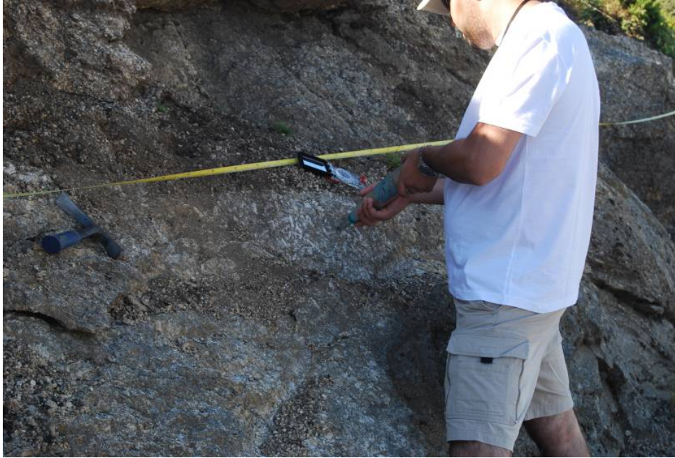
Figura 6 - Exemplo da utilização do martelo de Schmidt do tipo L durante o trabalho de campo.
