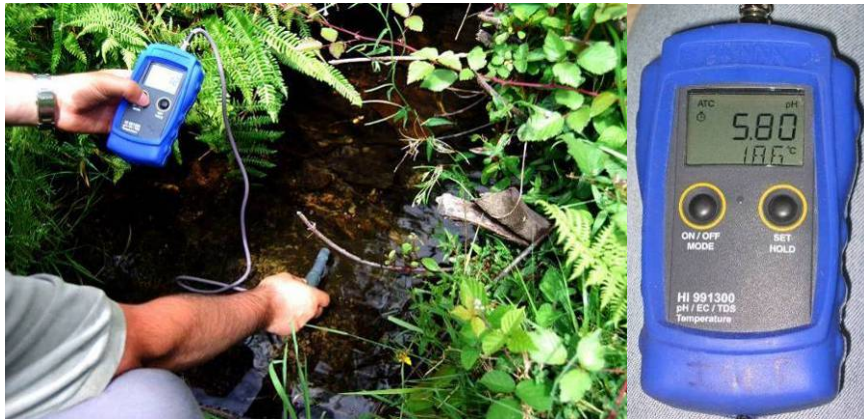
Figura 11 - Controlo in situ da temperatura, do pH e da condutividade eléctrica da água e aspecto de pormenor do equipamento portátil da Hanna® Instruments HI991300.
