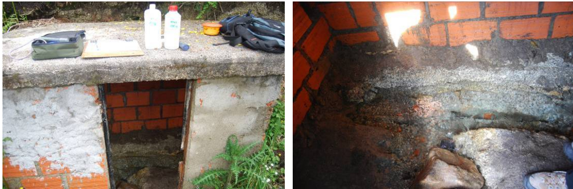
Figura 218 – Aspecto da amostragem de água para análise físico-química e da fractura de atitude aproximada N10°W-80°NE, na Nascente da Urzela (PI12, cf. quadro 32).
