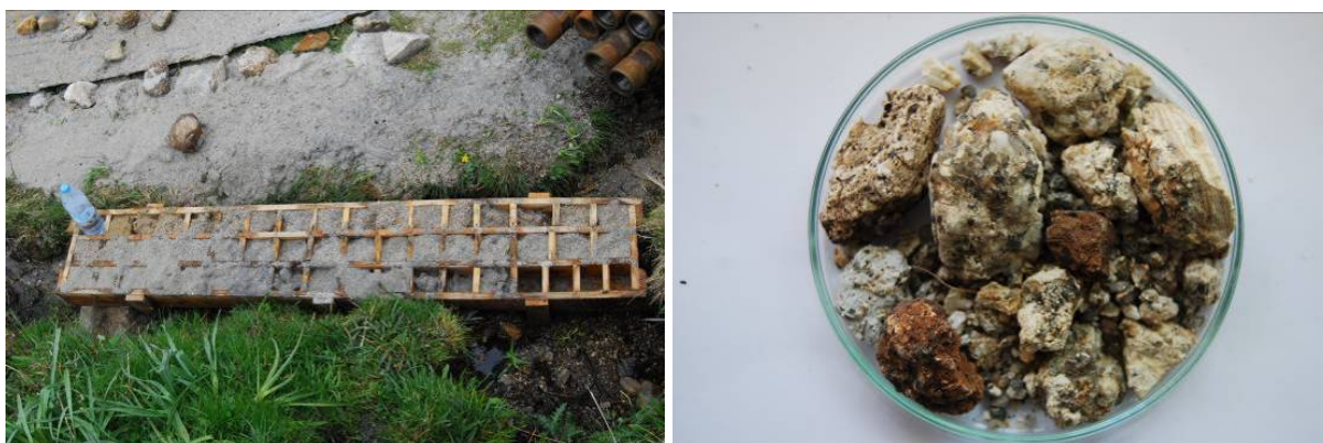
Figura 223 – Aspecto das amostras de FH2 logo após o final da furação (esquerda) e aspecto de amostra de zona fracturada em FH1 (direita).
