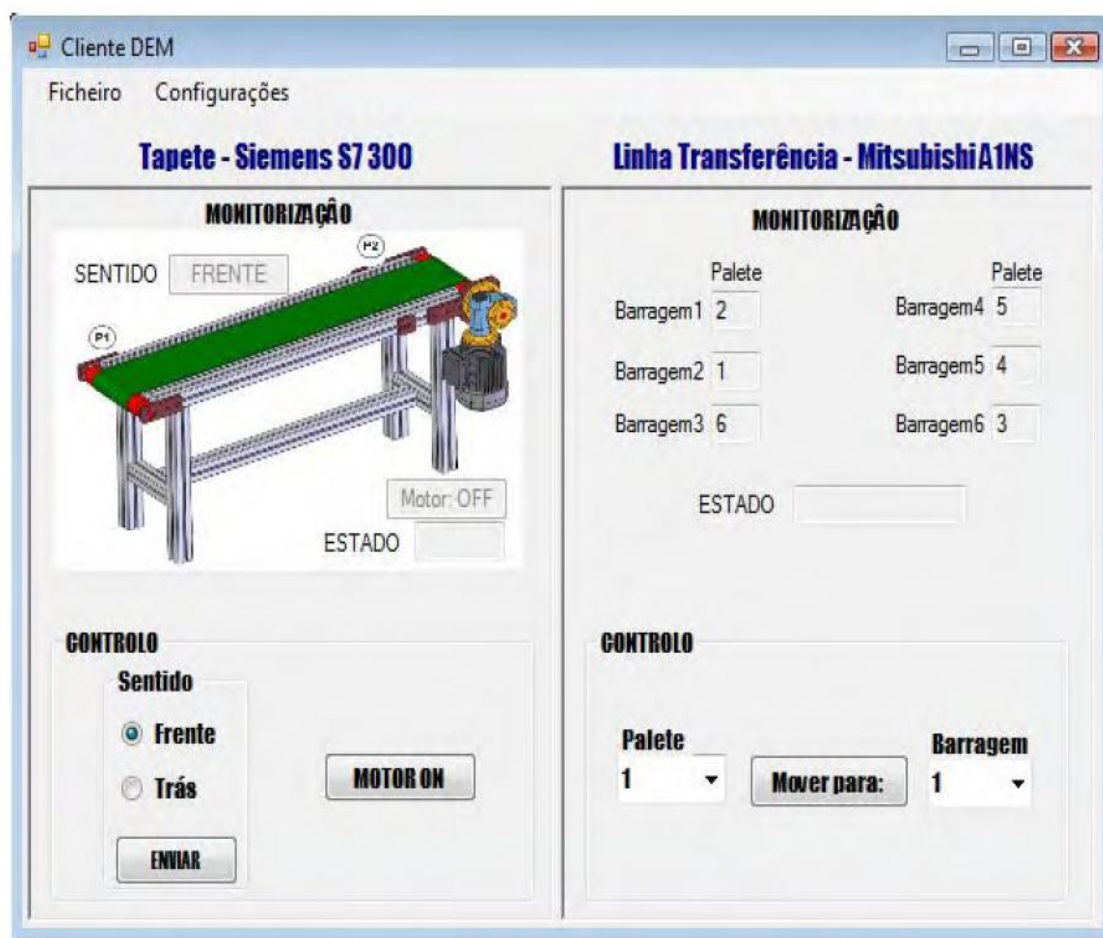
Figura 2. 12 - Sistema SCADA Cliente DEM [Silva e Costa, 2009].
