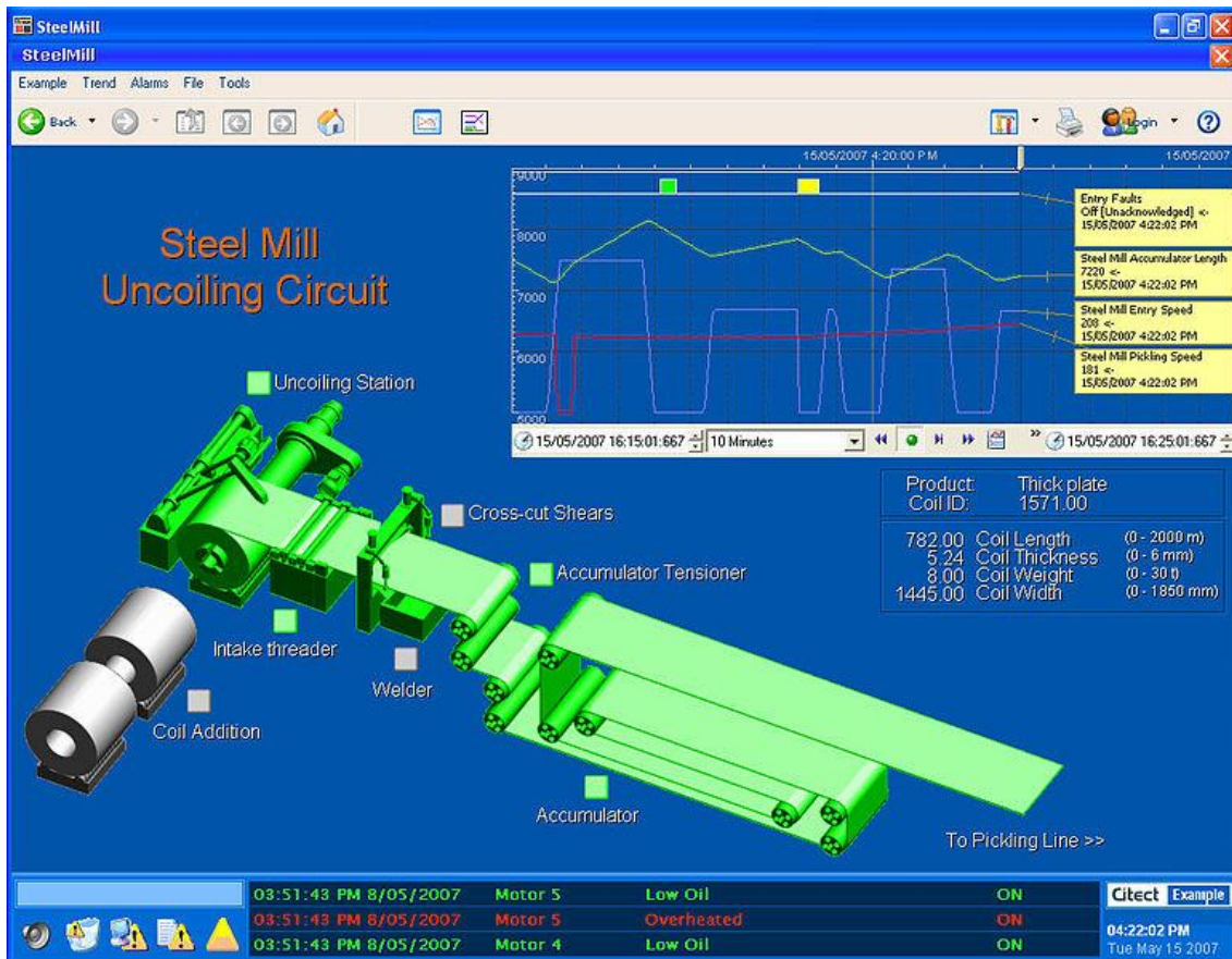
Figura 2. 5 - Sistema SCADA desenvolvido utilizando CitectSCADA [Citect, 2011]
