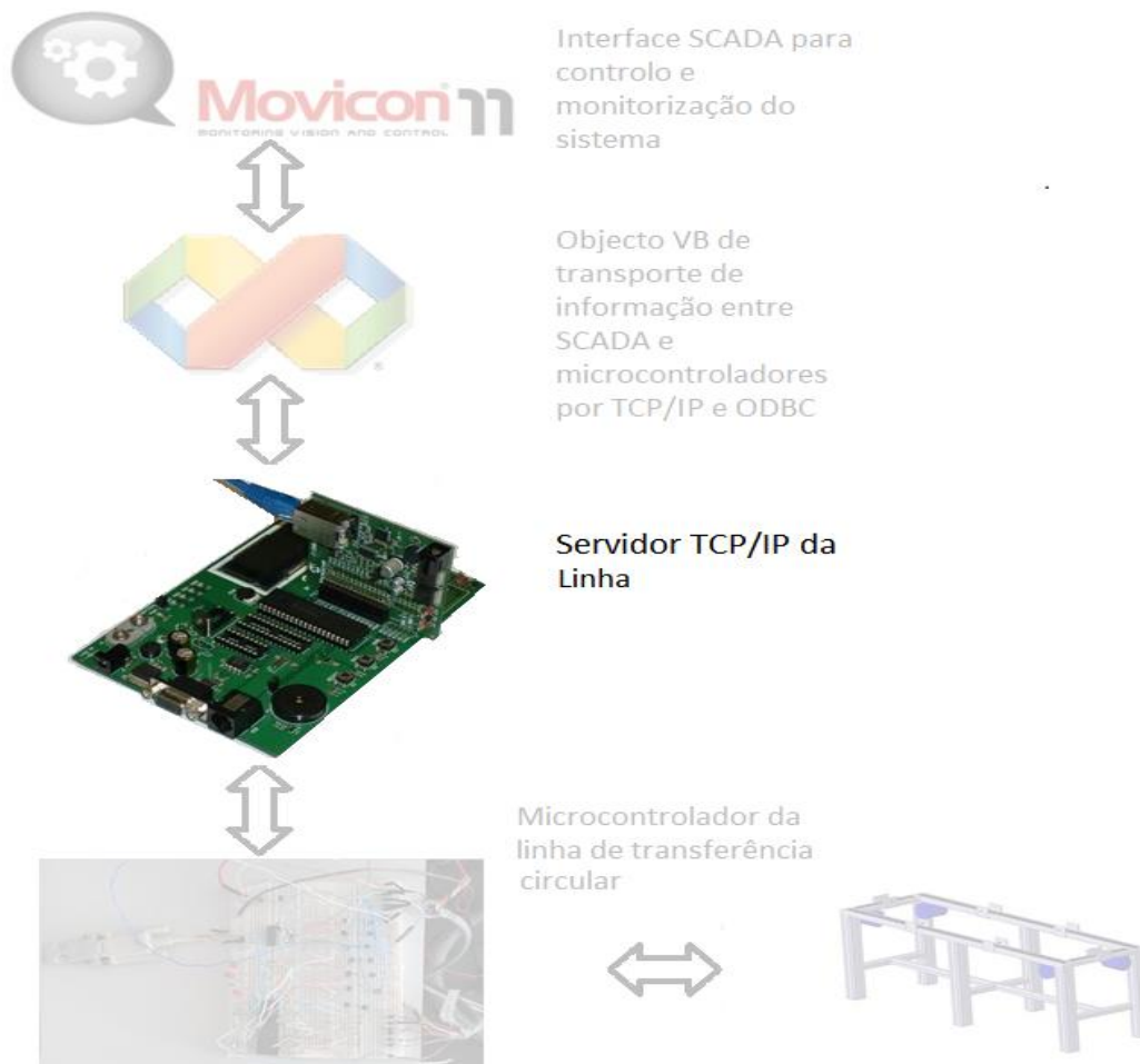
Figura 4. 11 - Esquema geral, destacando servidor de linha
