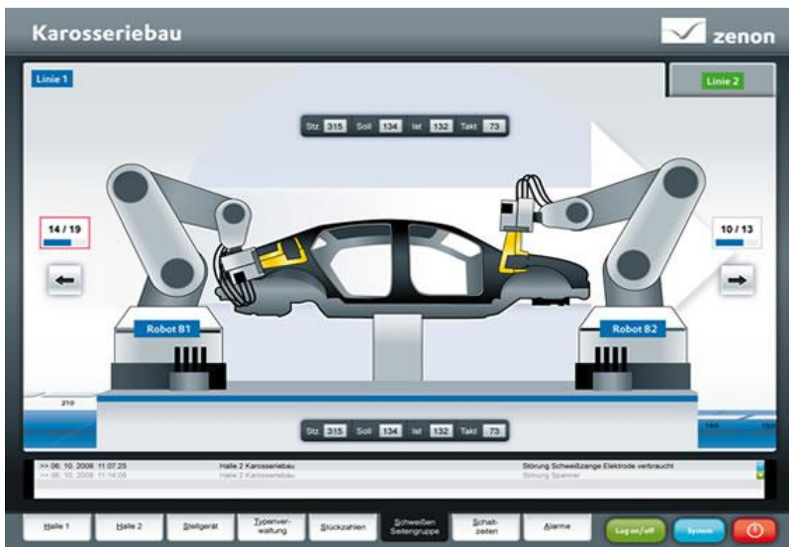
Figura 2. 6 - Monitorização e controlo de processo fabril utilizando a plataforma ZenOn [SPS Magazin, 2011].
