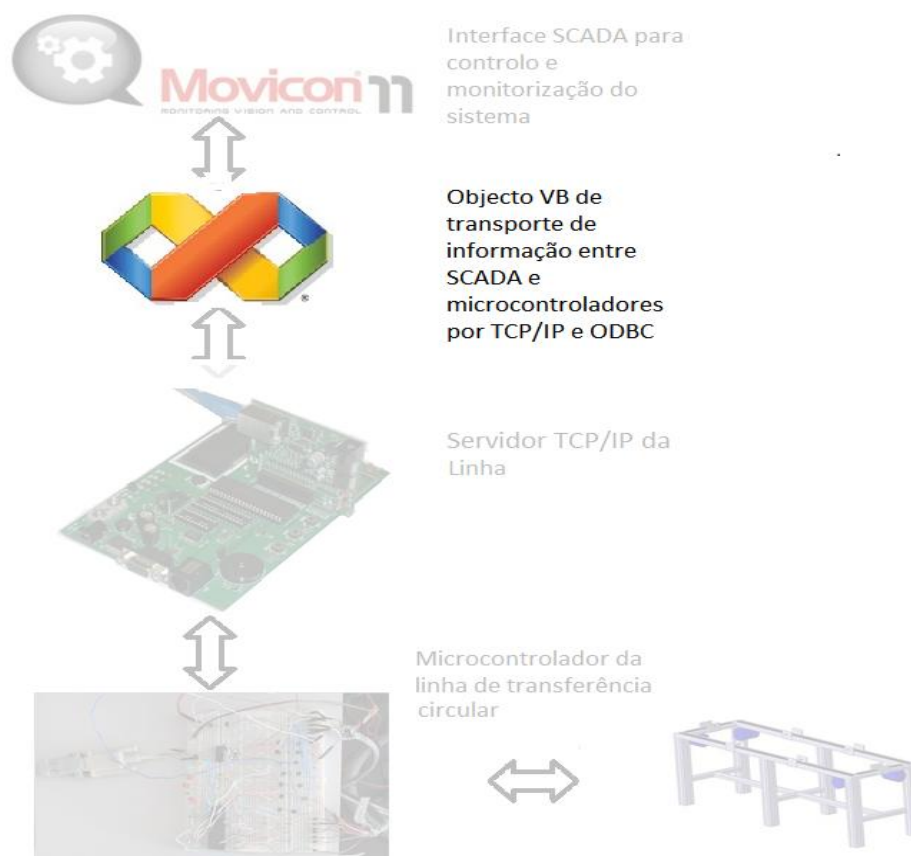
Figura 4. 14 - Arquitectura geral do sistema, destaque do cliente TCP/IP
