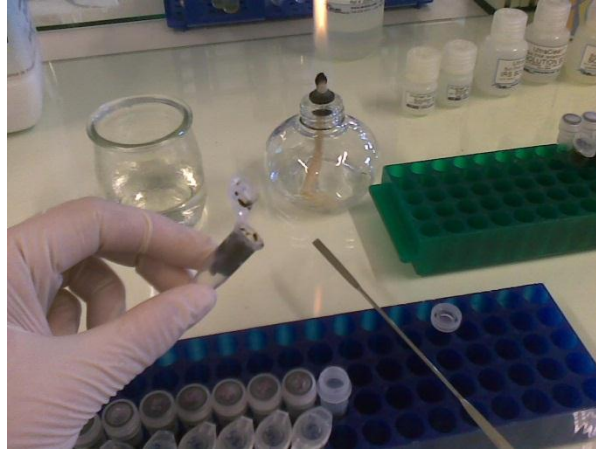
Figura 9: Transferência do sedimento recolhido dos microcosmos para tubos com beads provenientes do kit.
