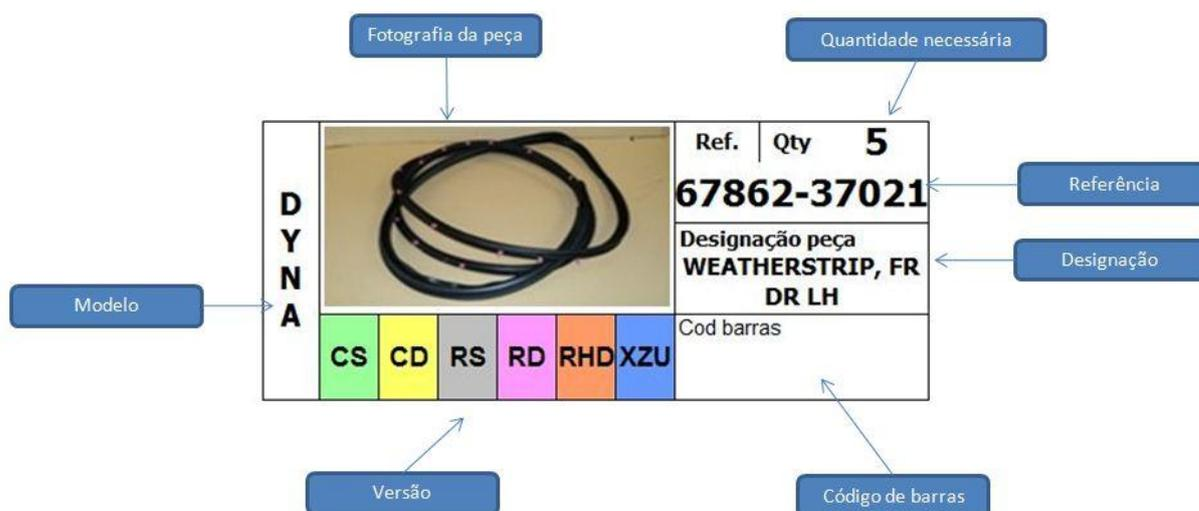
Figura 44: Exemplo de etiqueta para material comum a todas as versões DYNA.
