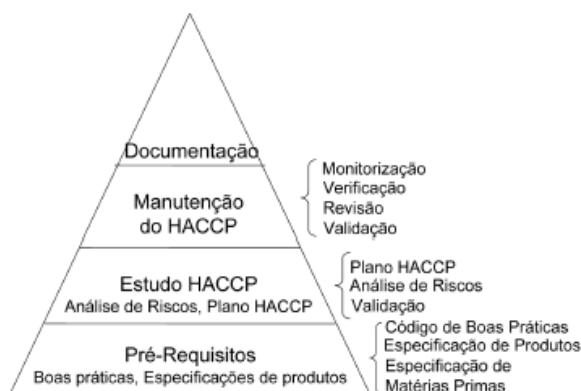
Ilustração 7 - Identificação da ligação entre documentos e registos com a estrutura do Sistema HACCP [15].
