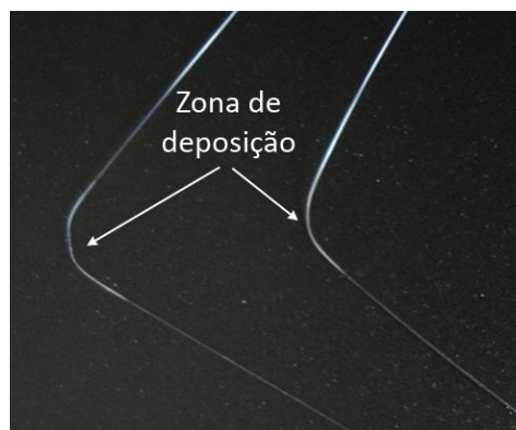
Figura 6.11 – Imagem da fibra óptica revestida com diamante, com realce para a curvatura obtida na zona depositada.
