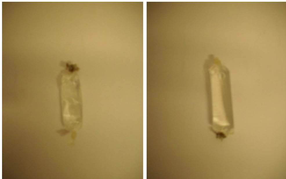
Figura 15: Membrana com a solução inicial de proteína e sal utilizada nos ensaios (imagem à esquerda) e membrana no fim do ensaio, quando se retirava do dispositivo experimental (imagem à direita).
