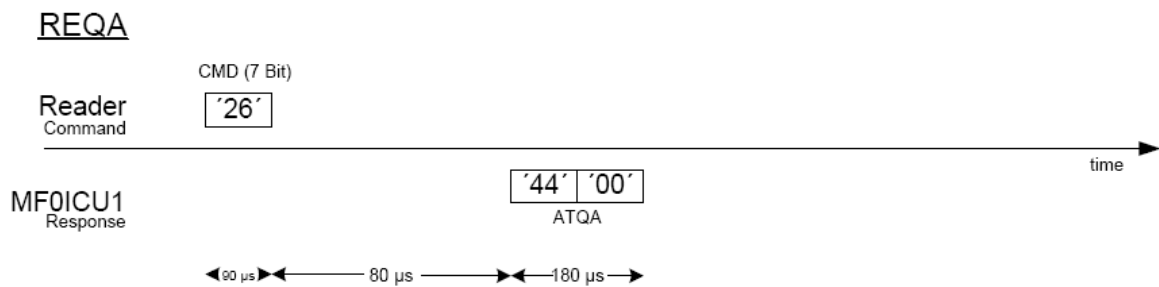
Fig. 41) Protocolo ISO14443A - Comando REQA, retirado de [17]
