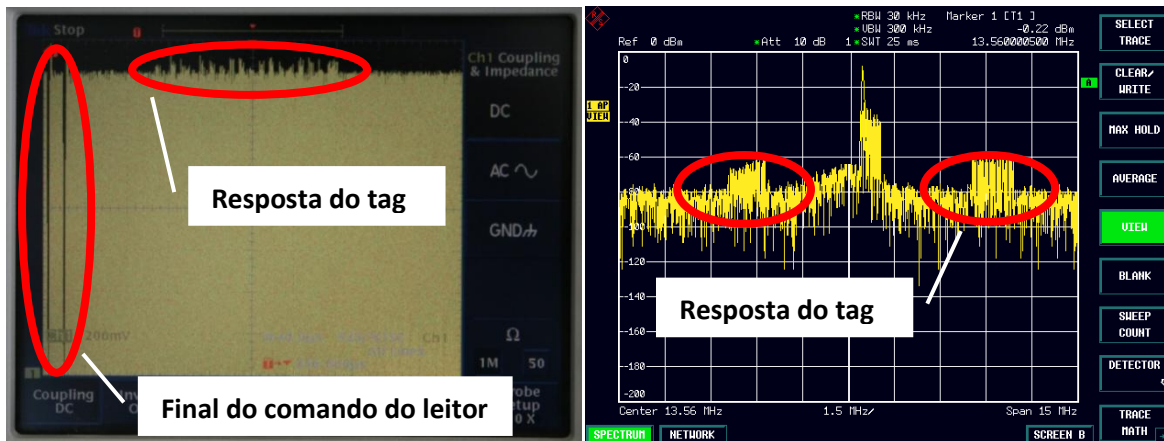
Fig. 59) Modulação de carga (tag). a) Domínio temporal; b) Frequência
