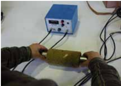
Fig. 2 – Ensaio com Pundit a um carote e resultados dos ensaios.
