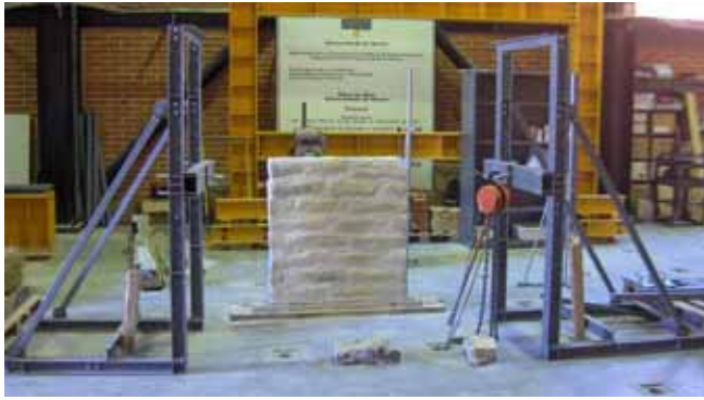
Fig. 4 – Parede, pórticos de reacção e gráfico força vs. deslocamento.
