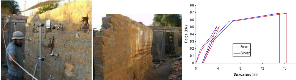
Imagem 08 – Ensaio fora do plano da parede *in-situ*: transdutores; aplicação da força horizontal; resultados.
