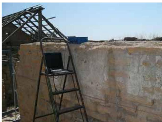
Imagem 06 – Leitura com recurso a sismógrafo de acelerações (para estimar as frequências próprias).
