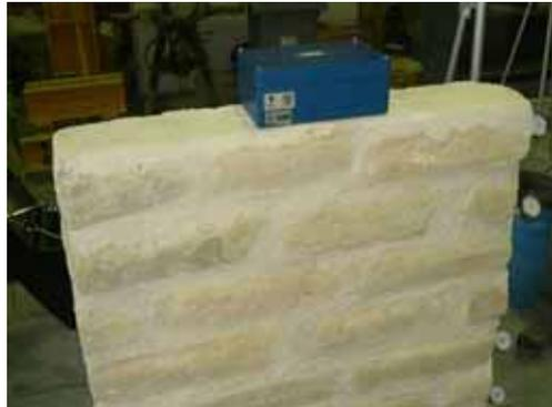
Imagem 02 – Leitura, através de um sismógrafo, das frequências próprias.
