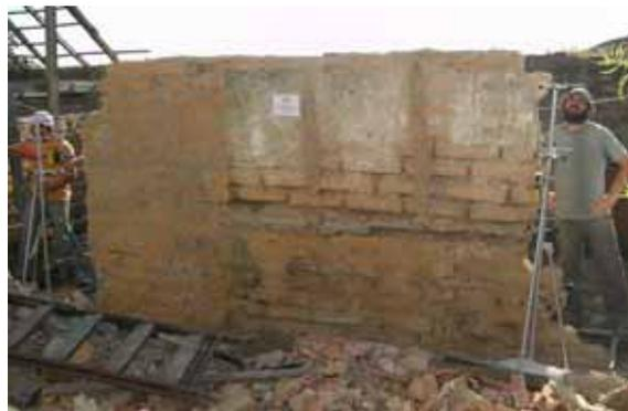
Imagem 05 – Esquema de ensaio da parede *in-situ*: pórticos de reacção, transdutores de deslocamento, dinamómetro e sistema de aplicação de forças horizontais na parede.
