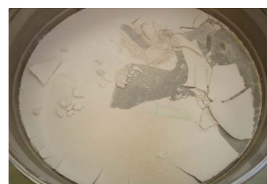
Figura 4.f - Passados no peneiro 63 µm
