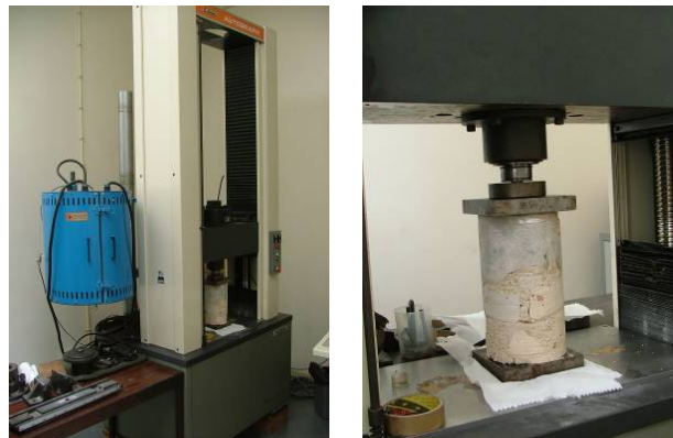
Figura 13: Ensaio de compressão axial das carotes
