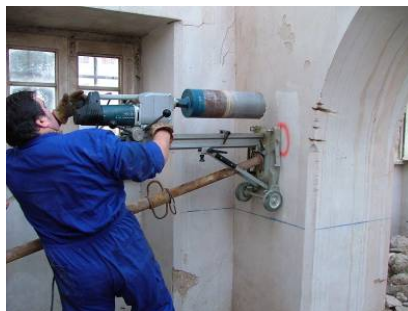
Figura 10: Extracção de carotes in situ
