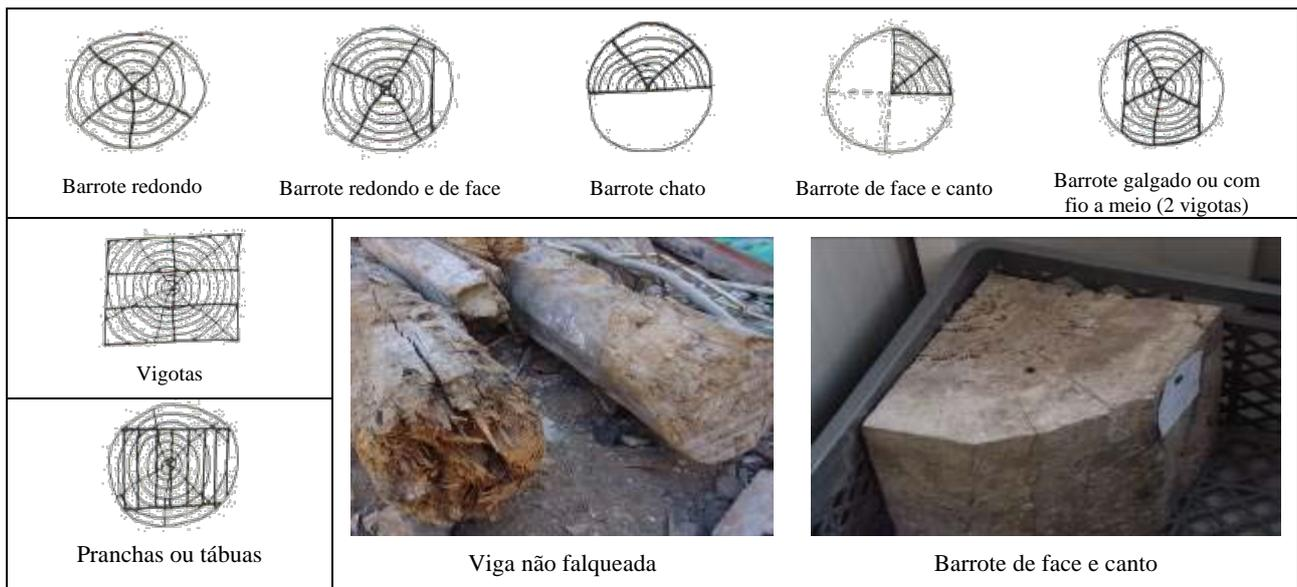
Figura 8: Secção e corte de peças de madeira [5]
