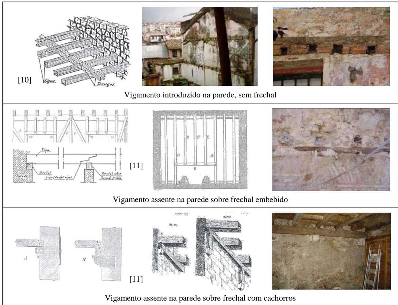
Figura 11: Ligações entre pavimentos e paredes
