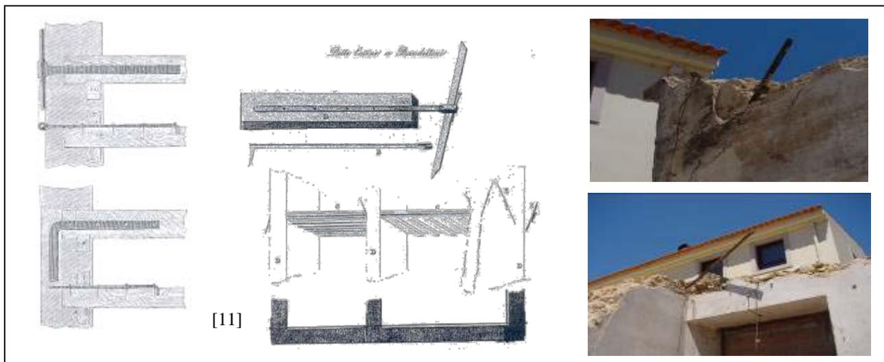
Figura 12: Ligações com elementos metálicos
