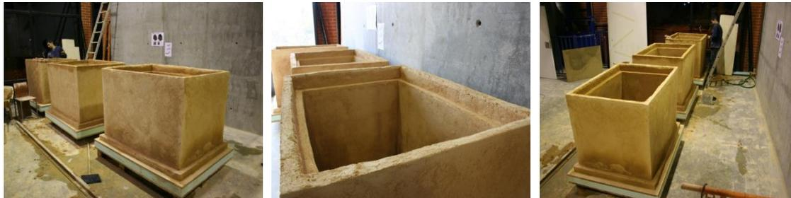
Fig.9.- Reboco das três células de teste.
