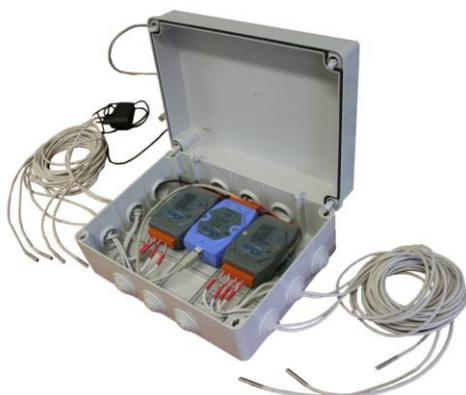
O sistema permite registar temperaturas em 12 pontos em simultâneo com uma precisão de 0,01 °C, através de sensores do tipo PT100. Os sensores PT100 garantem uma precisão elevada e permitem um amplo registo de temperaturas ( $\approx -100$  a  $+200$  °C) em meios sólidos e líquidos, uma vez que possuem as pontas de prova encapsuladas (liga metálica).
