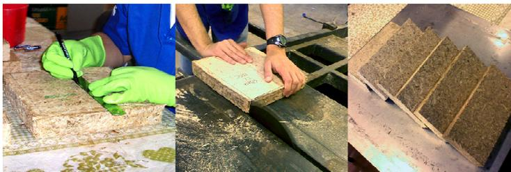
Figura 3 - Preparação dos blocos para o ensaio acústico.
