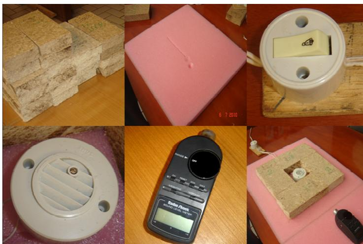
Figura 4 - Materiais dispostos para o ensaio acústico: blocos, placa de isopor, campainha e (cigarra) e decibelímetro.
