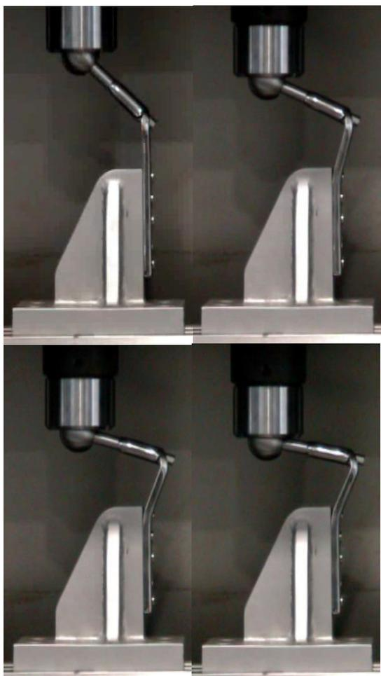
**Fig 12** – Evolução da deformação da placa no decorrer de um ensaio.
