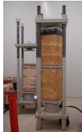
Figura 4 – Ensaios de pseudo-fluência: a) história de carregamento; b) bastidor de ensaio; c) dispositivo para a medição dos deslocamentos.
