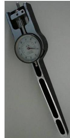
Figura 4 – Ensaios de pseudo-fluência: a) história de carregamento; b) bastidor de ensaio; c) dispositivo para a medição dos deslocamentos.
