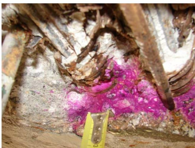
Medida “in situ” de la profundidad del frente carbonatado de hormigón
