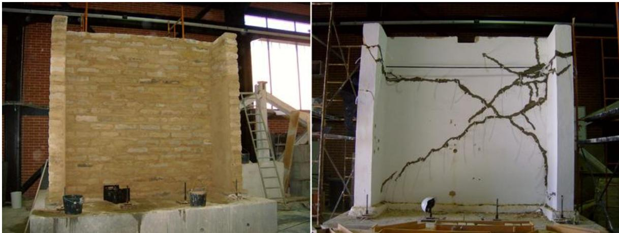
Figura 1: Parede de Adobe. Estrutura interna (esquerda). Aspecto após os testes mecânicos e reparação (direita).
