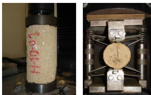
Figura 2: Ensaios à compressão simples e à compressão diametral sobre provetes de adobe
