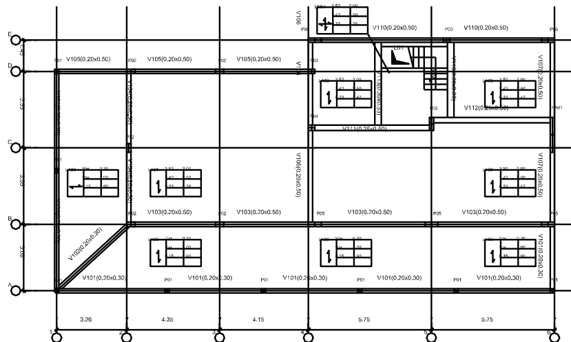
Figura 6 - Planta estrutural do piso 1 - Solução tradicional
