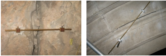
Fig 9 – Fixação dos sensores para medição de abertura de junta e deslocamento relativo paralelo à junta.
