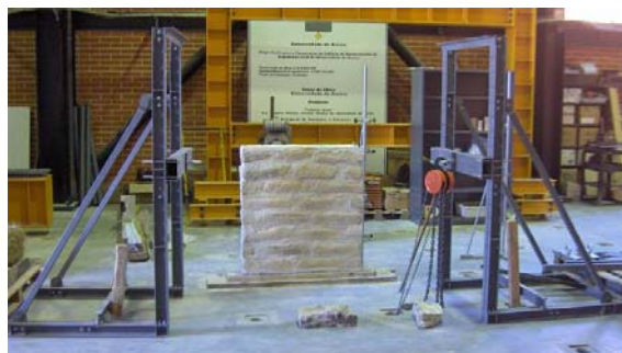
Fig. 8 – Dispositivo de ensaio cíclico da parede de adobe em laboratório.
