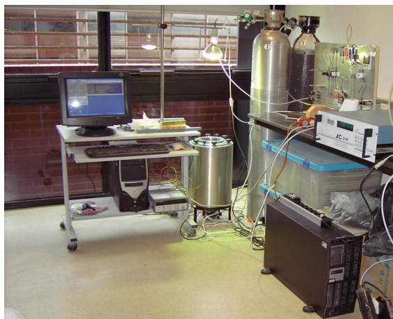
Figura 20. Reator utilizado nos ensaios de descontaminação gasosa.
