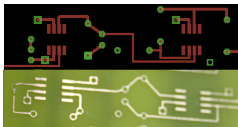
Figura 5.3: Pormenor do esquema da placa (em cima) e da PCB antes de furada e montados os componentes.
