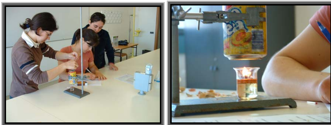
Figuras 6.15 e 6.16 Calorímetro rudimentar para estimar as calorias da combustão do óleo alimentar
