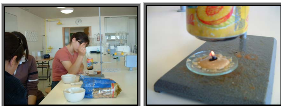
Figuras 6.17 e 6.18 Calorímetro rudimentar para estimar as calorias da combustão do Amendoim
