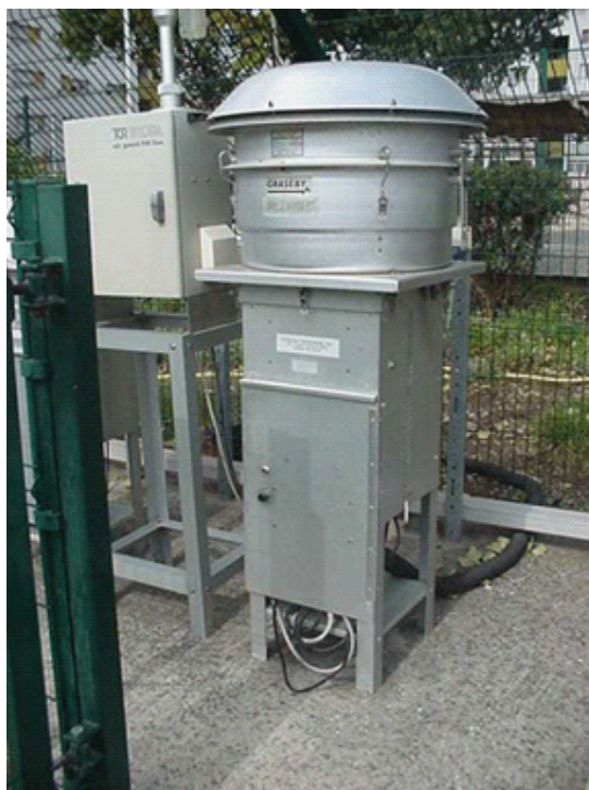
Figura 41: Amostrador de Alto Volume Andersen® com cabeça de amostragem PM 10 utilizado na campanha
