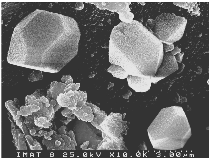
Figura 3.34. Microfotografias SEM obtidas para a gama de tamanho 125–250 µm, após tratamento isotérmico a 840°C (4h). Ataque com HF (5%, 8s).
