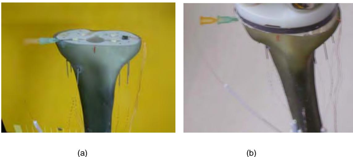
Figura 6.9 – (a) Sensor FBG de temperatura encapsulado na agulha e as FBG inseridas nos furos para monitorização da cura do cimento ósseo, antes da deposição do cimento e (b) depois da cimentação.
