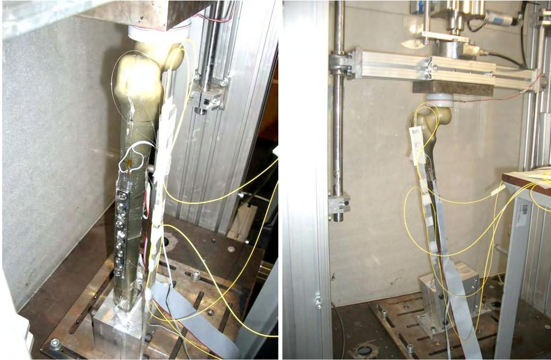
Figura 4.2 - (a) Fémur sintético fracturado e a placa de osteossíntese com as fibras ópticas no sistema de pressionamento; (b) Visão frontal do fémur e do dispositivo metálico de suporte do fémur na região distal.
