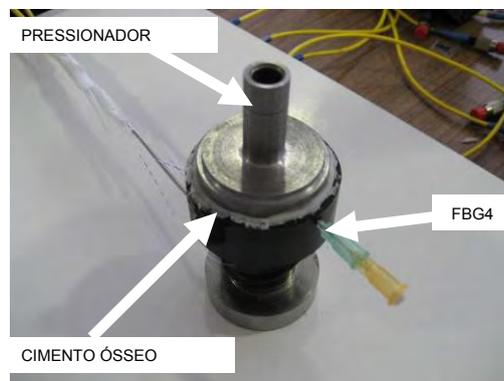
Figura 3.4 – Célula de carga de cimento ósseo com as FBG embutidas.
