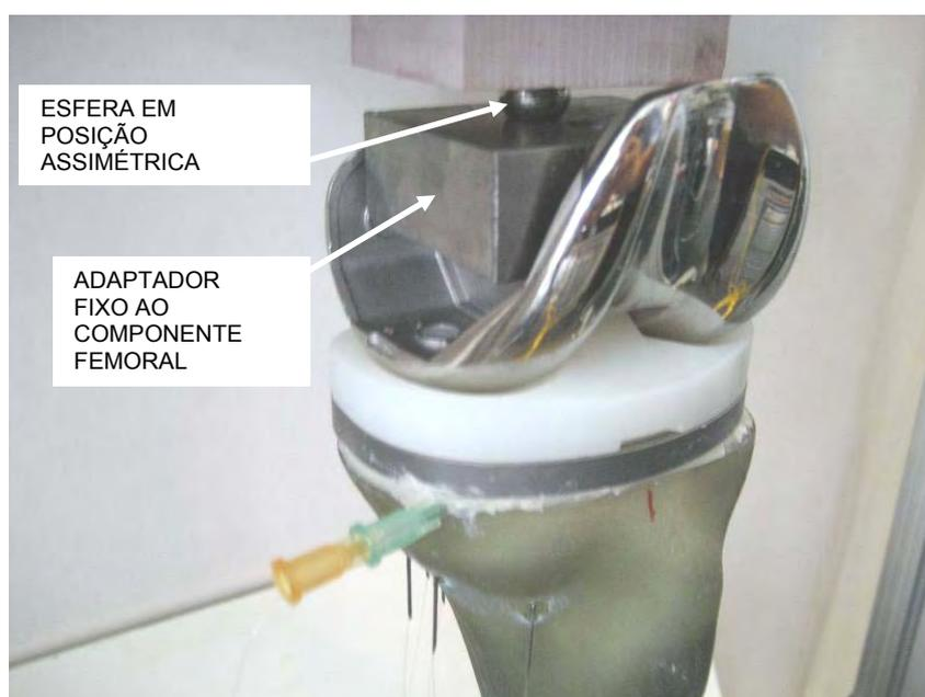
Figure 3.19 – Detalhe da prótese de joelho durante o ensaio com a aplicação de carga em distribuição assimétrica.
