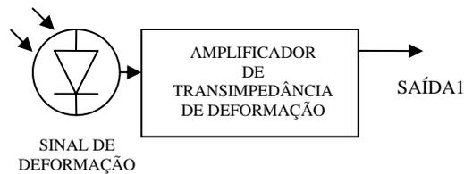
Figura 5.7 – Primeiro estágio interno do amplificador de sinal de deformação.
