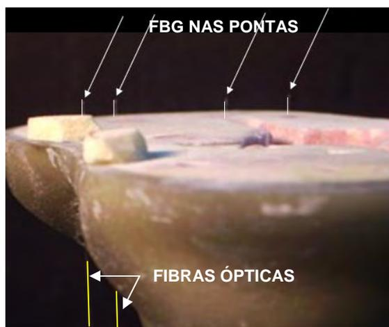
Figure 3.17 – Corte na tíbia sintética e fibras ópticas sensoras inseridas. As FBG estão localizadas nas pontas das fibras.
