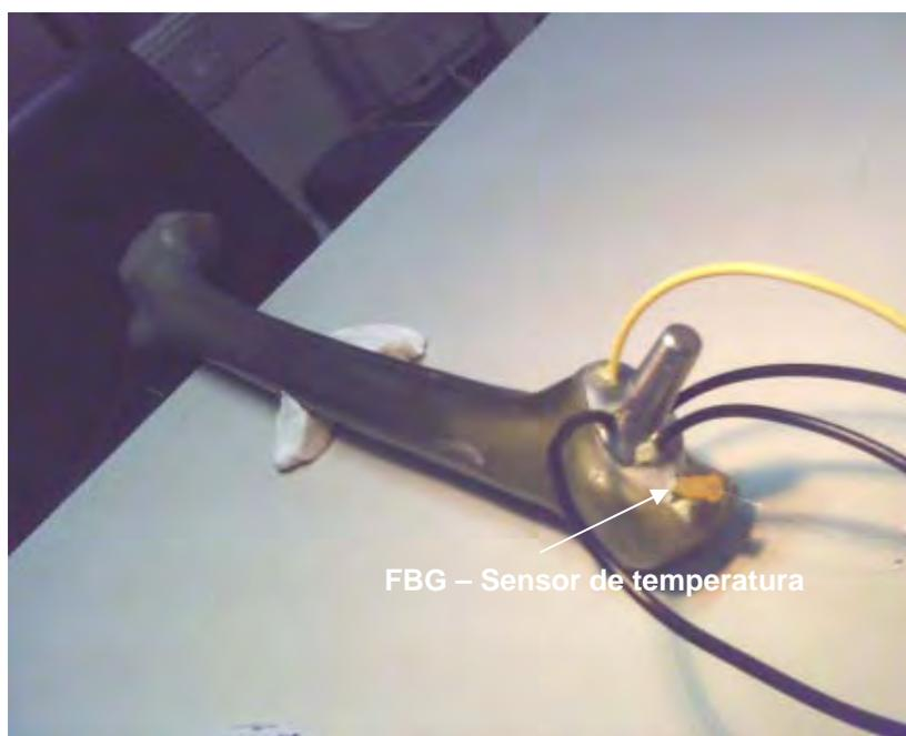
Figura 6.7 - Prótese da anca introduzida num fémur sintético e a FBG encapsulada para monitorização de temperatura, não sujeita às deformações mecânicas do cimento.
