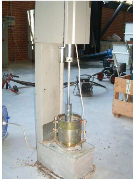
Figura 4.11 - Ensaio Proctor (compactação por apiloamento)
