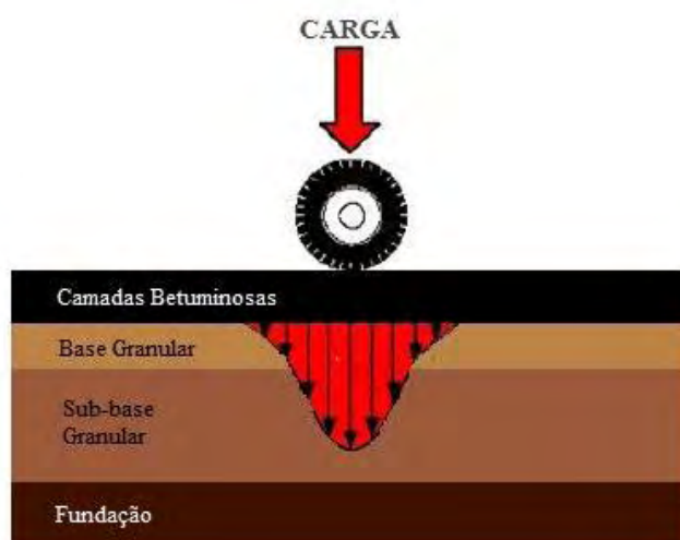
Figura 2.4 - Distribuição das tensões num pavimento flexível
