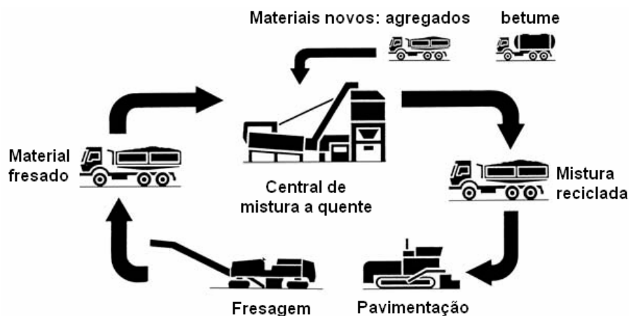
Figura 3.1 – Esquema do processo de reciclagem a quente em central (Baptista, 2006)
