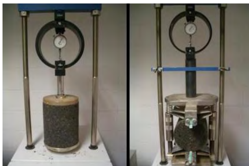
Figura 4.20 – Ensaio à compressão simples (esquerda) e ensaio à compressão diametral (direita) do FC
