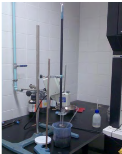
Figura 4.8 - Aspecto do ensaio do Azul-de-Metileno.
