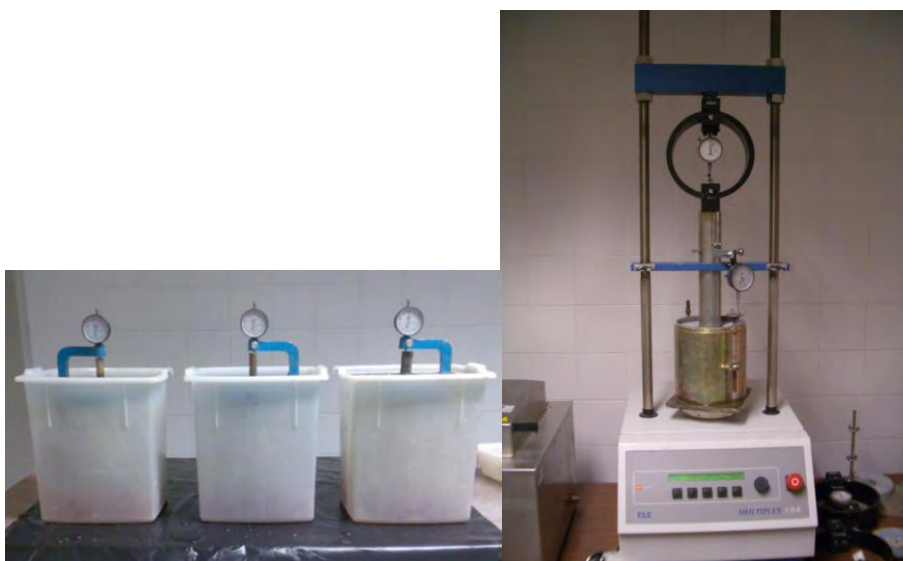
Figura 4.15 - Aspecto do ensaio CBR (imersão e ensaio de penetração)
