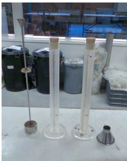
Figura 4.7 - Aspecto do ensaio de Equivalente de Areia
