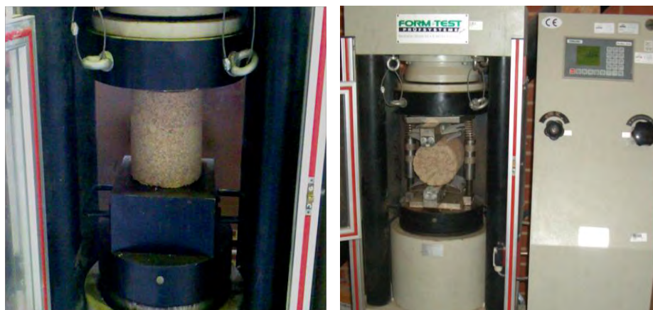
Figura 4.19 - Ensaio à compressão simples (esquerda) e ensaio à compressão diametral (direita) do AGEC
