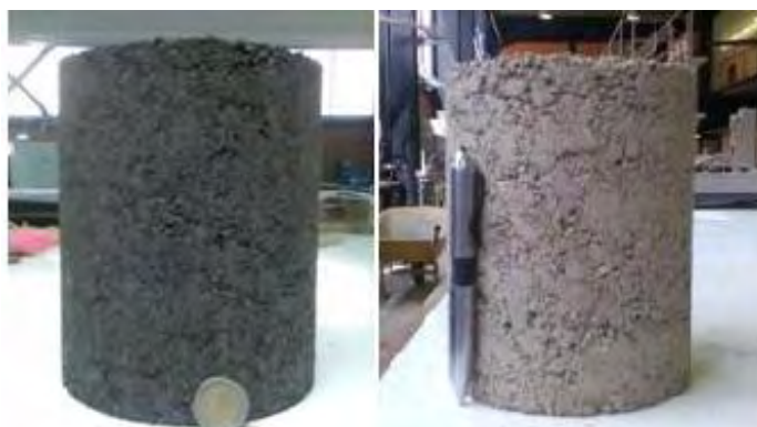
Figura 4.18 – Aspecto dos provetes após compactação e cura
