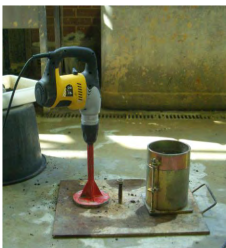
Figura 4.17 - Martelo vibrador usado na compactação dos provetes.
