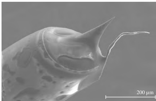
Figura III.4.11 – UME isolado com verniz das unhas, revelando a presença de muitos buracos.
