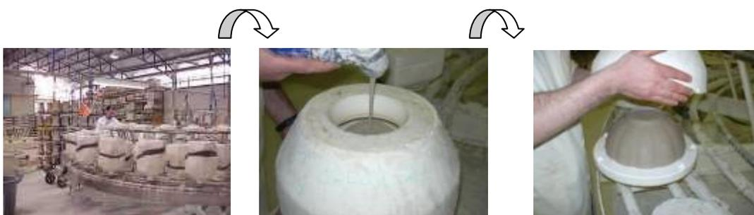
**Figura 24** – Processo de conformação por enchimento, no carrossel.
