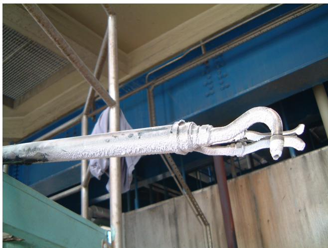
Figura 2.2. Aspecto de sonda de amostragem após caracterização em fonte com elevada concentração de partículas.
