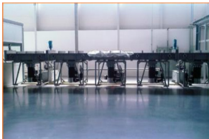
Fotografia 11 - Sputtering de alumínio
