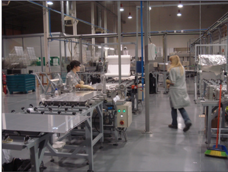
Fotografia 14 - Zona de aplicação de fita de alumínio e EVA
