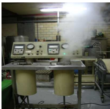
Figura 18: Equipamento onde se efectua o pré-tratamento com vapor ao engaço da uva.
