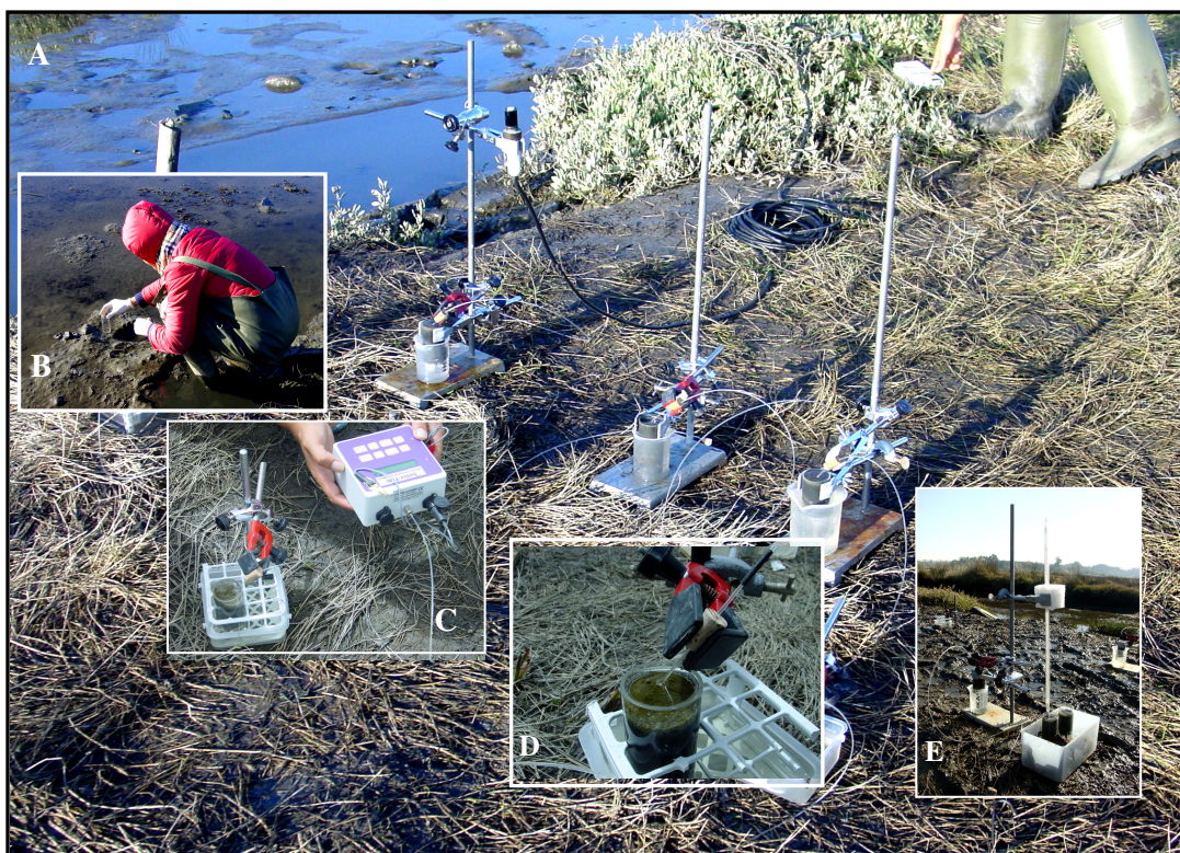
Figura 3. Sistema de medição de parâmetros de fluorescência in situ com as diferentes réplicas (A). Colheita das amostras (B). Fluorómetro PAM portátil (C). Posição da fibra óptica sob a superfície do sedimento (D). Medição de temperatura (E).
