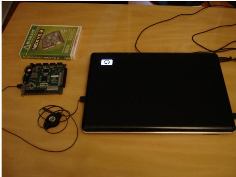
Fig. 5.8 – Ligação do computador pessoal com uma placa FPGA, através de USB.
