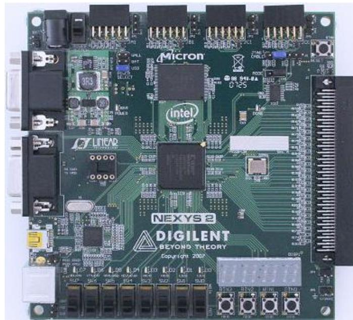
Fig. 2.4 – Placa com FPGA Nexys-2, desenvolvida pela Digilent Adept Inc.[13]
