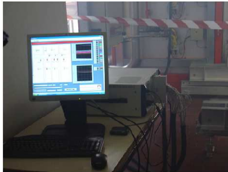
Figura 3-2 Sistema de aquisição de dados onde estão ligados os termopares da face não exposta (Jesus, 2008).
