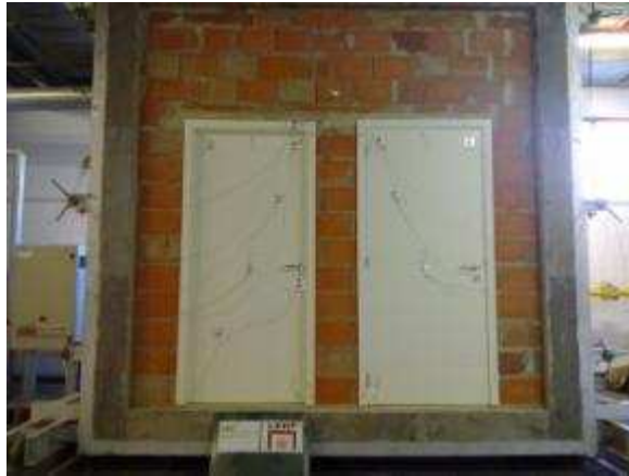
Figura 3-18 Face não exposta da amostra a ensaiar.
