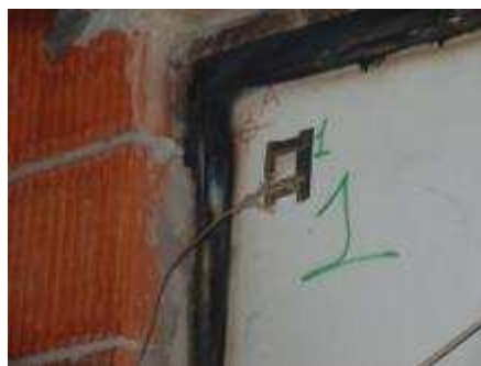
Figura 3-14 Zona da porta A por onde se observou a chama aos 58 minutos.
