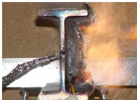
Figura 2-13 Reacção da tinta intumescente (Mesquita, et al., 2006).
