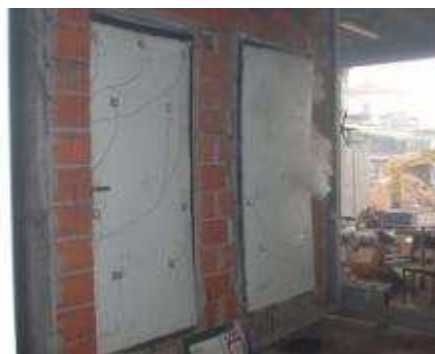
Figura 3-13 Deformação das portas aos 46 minutos.
