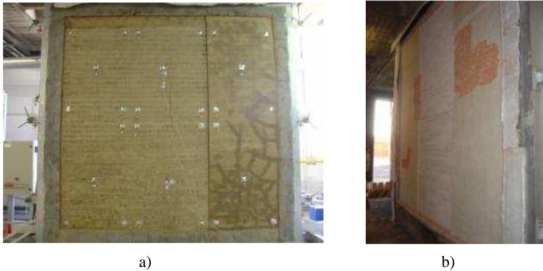
Figura 4-4 Amostra após o ensaio a)Face não exposta b)Face exposta (Vila Real, et al. , 2009).
