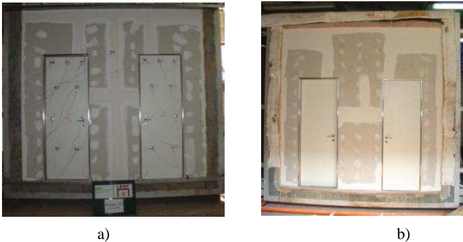
Figura 3-4 Amostra antes da realização do ensaio a)face não exposta b)face exposta.
