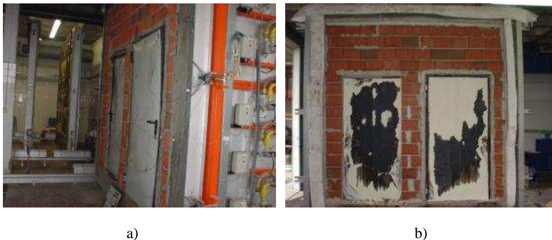
Figura 3-15 Registo final da amostra. a) Deformação final das portas b) Parte exposta ao fogo depois do ensaio.
