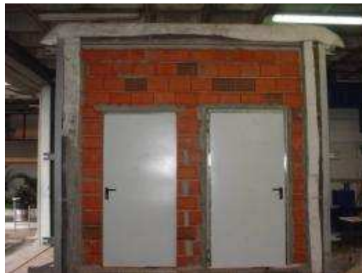
Figura 3-8 Amostra da face exposta ao fogo antes da realização do ensaio
