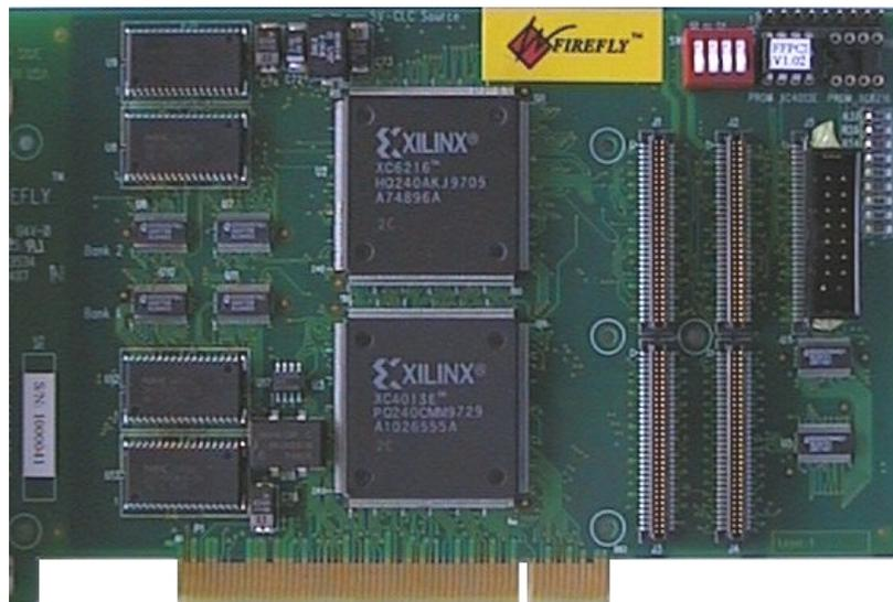
Figura 6.3 – Vista da implantação de componentes da placa de desenvolvimento *FireFly*<sup>TM</sup>.
