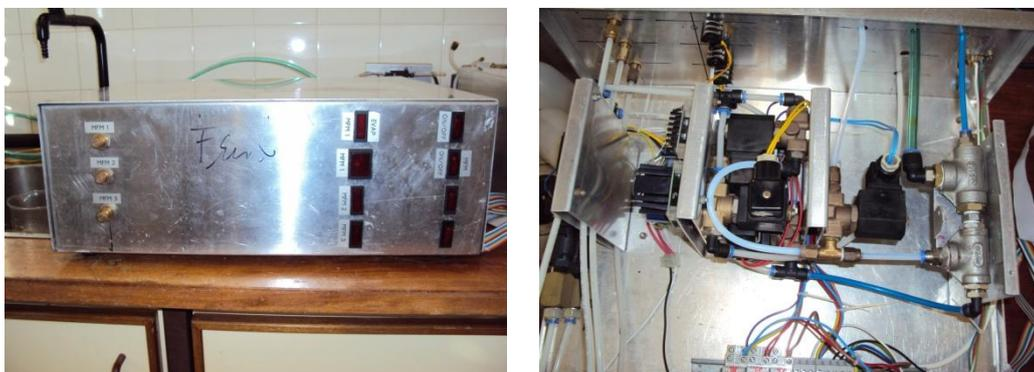
Figura 3.3 – Vista exterior e interior do sistema de diluição de misturas gasosas
