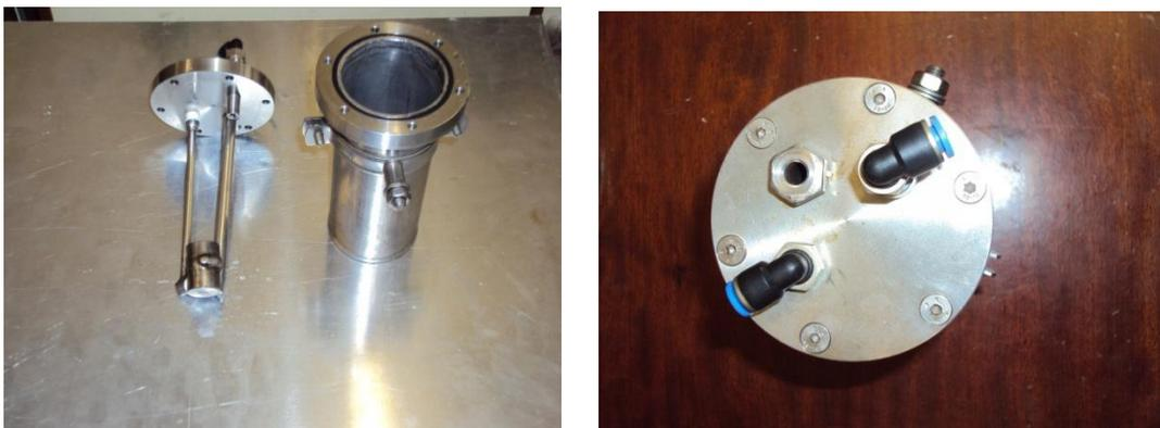
Figura 3.5 - Sistema de evaporação de soluções aquosas
