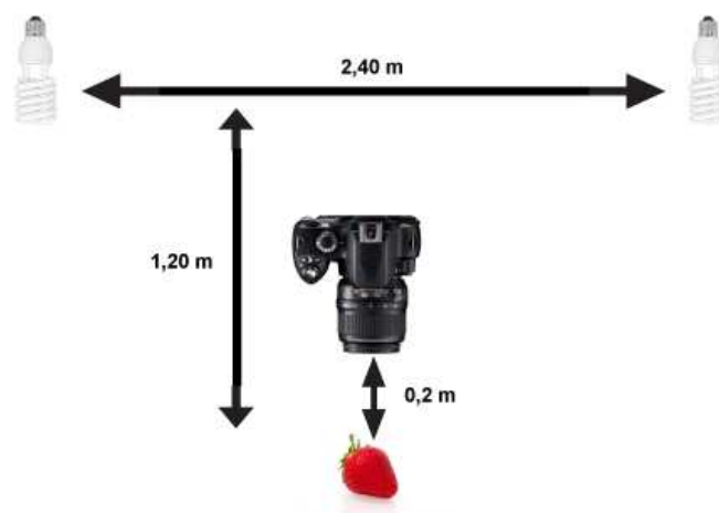
Figura 3.6 | Esquema representativo do modo de obtenção de imagem.
