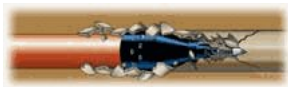
Figura 17. Pipe bursting : Ilustração do processo de destruição [29]
