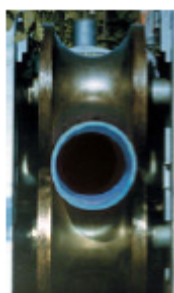
Figura 16. Pormenor da técnica rolldown , durante a fase de redução do diâmetro [29]
