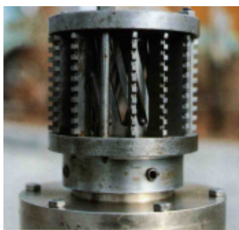
Figura 12. Dispositivo de aplicação de argamassa cimentícia [29]
