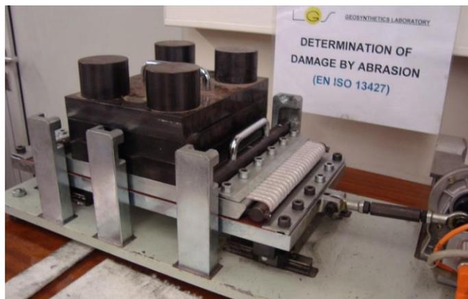
Figura 17. Colocação dos pesos sobre a placa superior do equipamento de abrasão.
