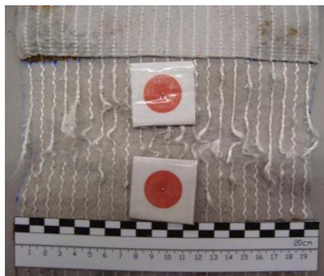
Figura 42. Amostra de GCR submetido a DDI, após o ensaio de tracção.
