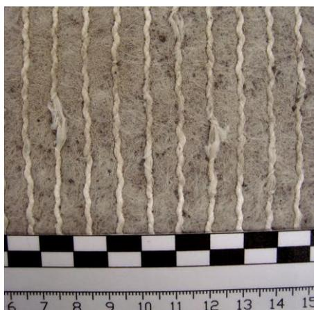
Figura 41. Pormenor do aspecto dos filamentos do geossintético GCR, após ensaio de DDI.
