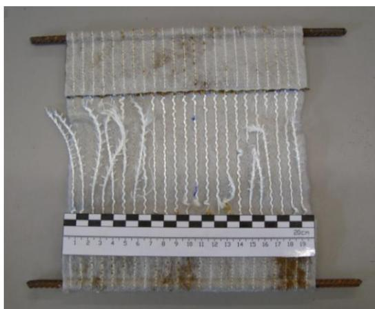
Figura 39. Aspecto apresentado pelo geocompósito GCR após ensaio de tracção.
