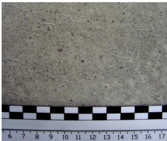
Figura 32. Aspecto do geotêxtil GTX após ensaio de DDI em laboratório.
