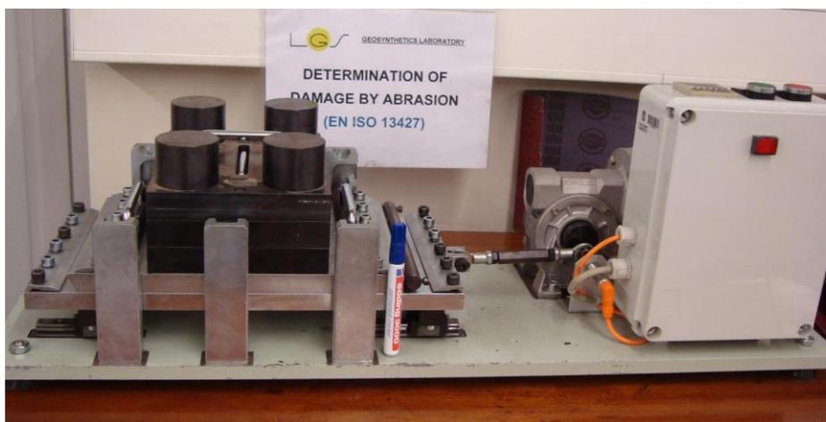
Figura 12. Equipamento laboratorial para simulação da abrasão de acordo com a NP EN ISO 13427 (2006).
