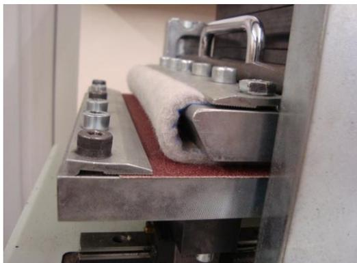
Figura 19. Deslocamento da placa superior em relação ao provete de geotêxtil durante o ensaio laboratorial de abrasão.
