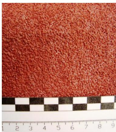
Figura 20. Aspecto da película abrasiva P24 utilizada para fixar o provete de geotêxtil à placa superior.
