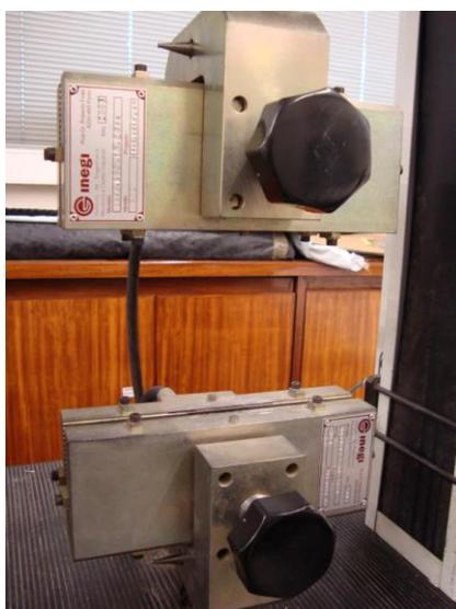
Figura 7. Garras hidráulicas utilizadas nos ensaios de tracção da geogrelha GGR.
