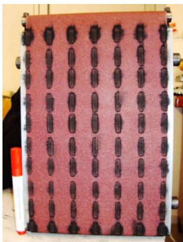
Figura 27. Película abrasiva após ensaio de uma amostra de geogrelha GGR.
