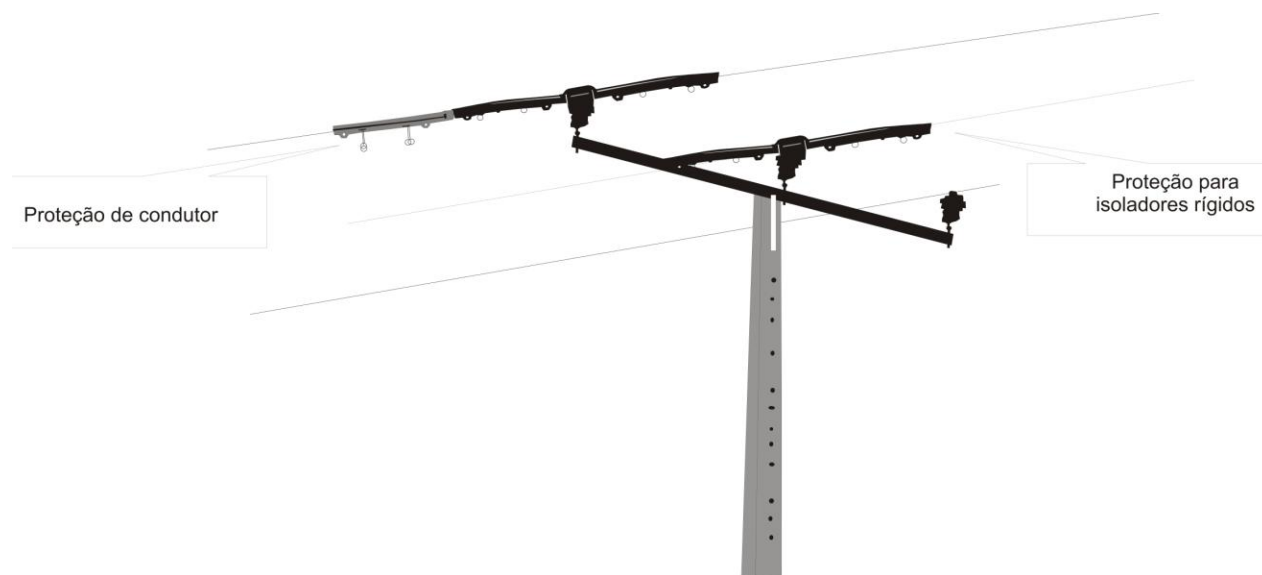
Figura 3 – Apoio de alinhamento em Esteira Horizontal, com exemplos de aplicação de Protector para isoladores rígidos (2) e Protector de condutor (condutor de fase mais à esquerda).
